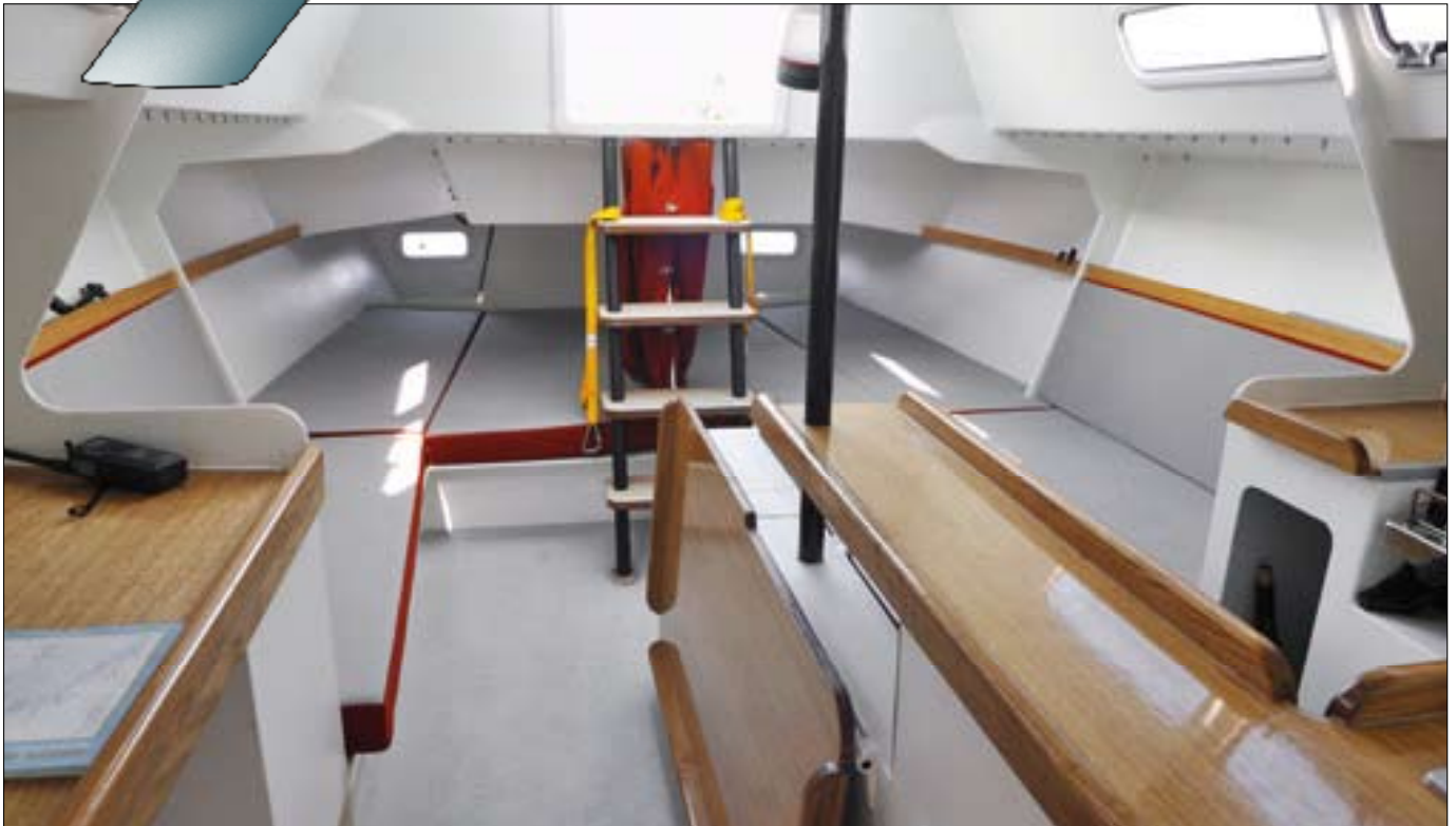
▲ Des emménagements décloisonnés. Pas terrible pour l'intimité, mais l'impression d'espace est vraiment agréable. Au fond, les deux couchettes doubles arrière, qui sont strictement symétriques. A noter aussi que la descente n'est pas très profonde malgré la présence d'un petit bridge-deck – un bon point!
